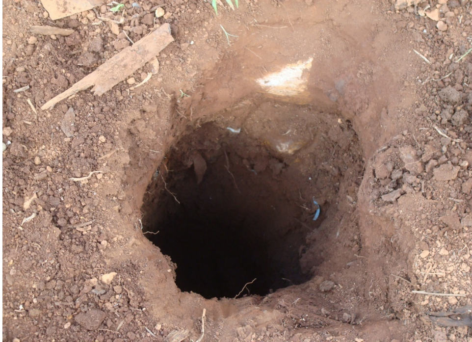
Figura 3: Poço de determinação da profundidade do lençol freático. Nota: foto tirada em 10/10/08.
